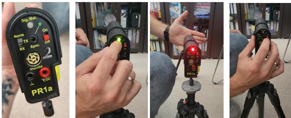
3.5. Нажимаем кнопку <On>. Двигаем фотоэлемент по направлению к отражателю, пока не загорится зелёный сигнал вместо красного
