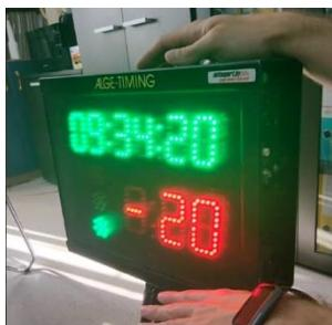
Если на часах интервал не синхронизировался со временем дня, дождитесь окончания минуты. Таймер обнулится и синхронизирует время старта с новой минуты. После чего часы заработают в нужном режиме.
