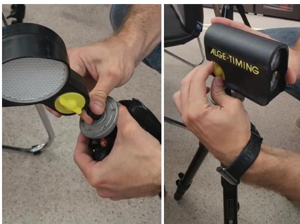
3.3 Устанавливаем Отражатель на одном конце финишной зоны. Безопасно, но близко к дороге. Ножками на штативе можно регулировать высоту. На противоположной стороне ставим Фотоэлемент, направляем устройства друг на друга через прицел.
