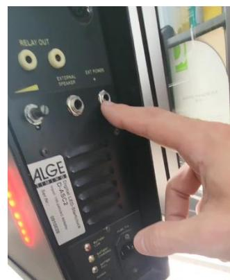
Либо в разъем (8) на 12 вольт от автомобильного аккумулятора.
