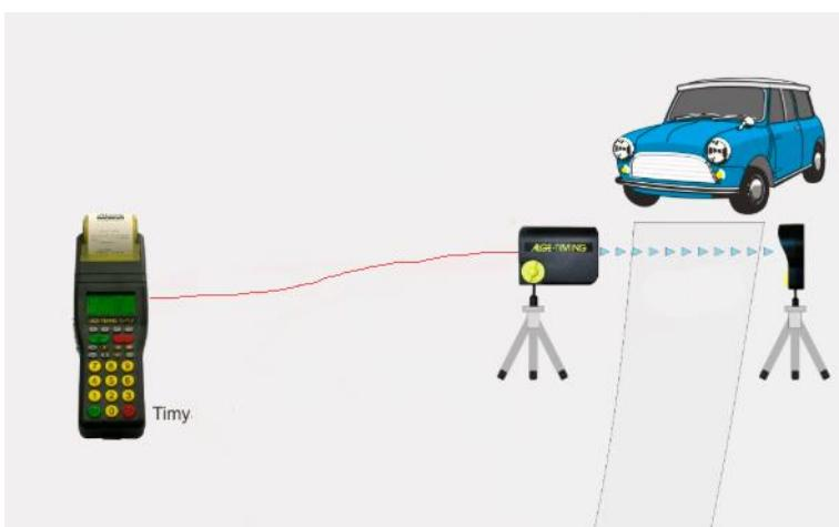
3.4. К фотоэлементу в разъём <Impulse> подключаем красный кабель (другой конец подключается к Таймеру Timy).
