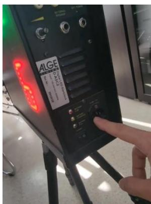
Для заряда аккумулятора устройства в разъем для зарядки батареи (12) на 220 вольт подключается шнур (подходит от стандартных ПК и мониторов).
