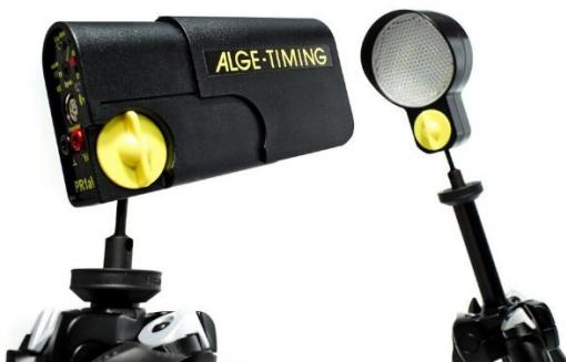
3.2 Установите Отражатель на штатив. Аккуратно подожмите пальцами в месте соединения со штативом, чтобы Отражатель не двигался. По тому же принципу ставим Фотоэлемент, аккуратно подкручиваем за желтое крепление, чтобы Фотоэлемент не двигался.
