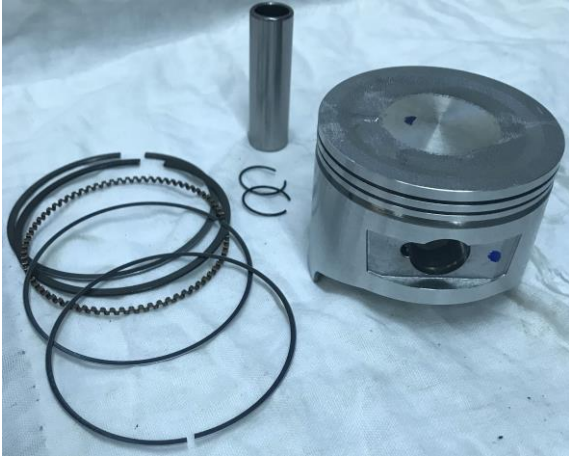
Фото 3: Поршень, кольца, палец и стопора
